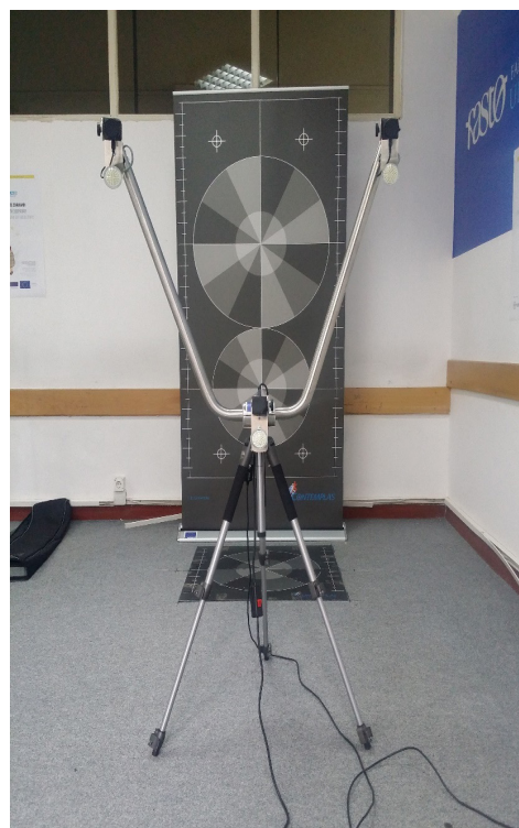
Figure 3. „V“ Camera Frame
